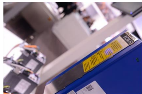
Das KCM-Modul erhöht die Energieeffizienz im Materialfluss, weil sich die Bremsenergie wieder für das Beschleunigen nutzen lässt.
